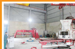
Dây chuyền sản xuất ống cống của hãng PFEIFFER CHLB Đức, công suất 100km cống/năm.
