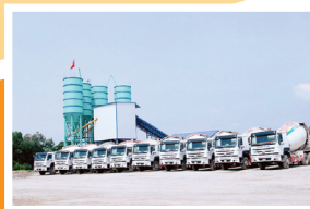
Dây chuyền sản xuất bê tông thương phẩm, công suất 210m 3 /h tại Cụm công nghiệp Cao Ngạn (TP. Thái Nguyên).
