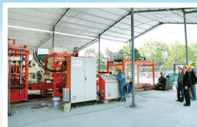
Dây chuyền sản xuất gạch không nung tự động hóa, công suất 10 triệu viên/năm.
