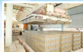
Nhà máy gạch Tuynel tại Cụm công nghiệp Cao Ngạn (TP. Thái Nguyên). Trong ảnh: Máy gắp gạch tự động của dây chuyền sản xuất gạch Tuynel.
