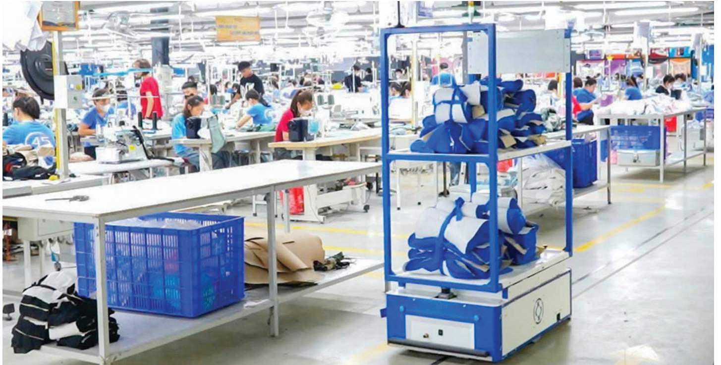
Xe tự vận hành AGV (do Công ty CP Đầu tư và Thương mại TNG chế tạo và sản xuất) vận chuyển bán thành phẩm tự động trong nhà máy may TNG.
